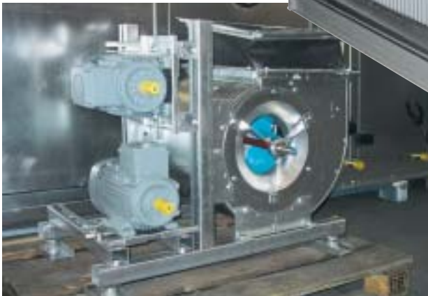
Doppelmotor für erhöhte Betriebssicherheit.
