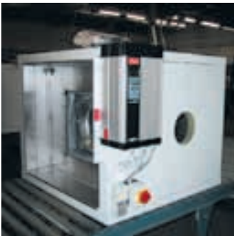
Frequenzumformer außen am Gerät montiert und verkabelt.
