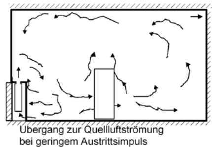
Abbildung 4.2: Der Übergang von einer Tangential- zur Quelllüftungströmung.
